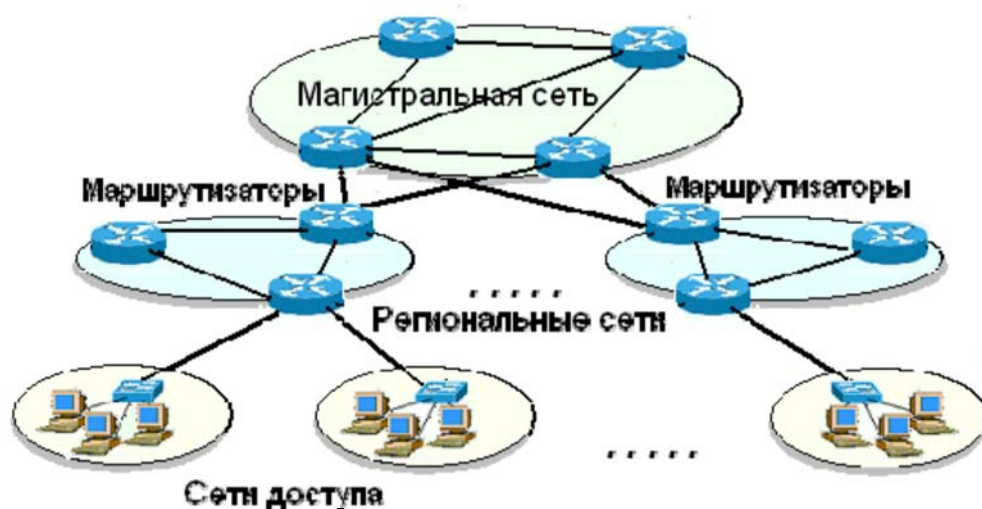
Трехуровневая архитектура сети
